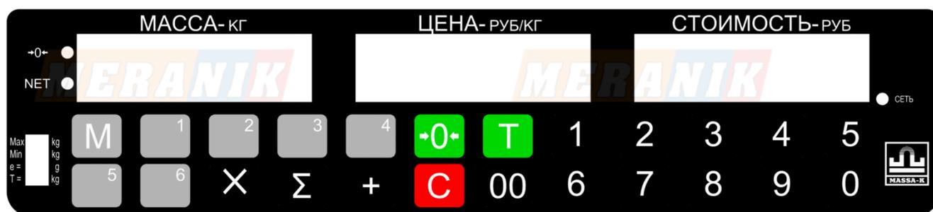
Рисунок 2 – Лицевая панель устройства управления. Клавиатура
